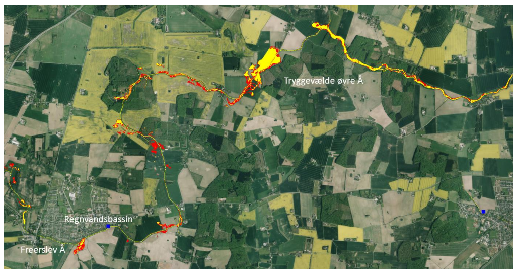
Figur 7: Scenarieberegninger ved hhv. 0,77 l/sek/ha markeret med gult og 1 l/sek/ha markeret med rødt for Freerslev Tryggevælde Å øvre. De farvede områder er områder, hvor terrænet ligger lavere end de beregnede vandspejl. Det ses, at en enkelt af de farvede arealer ligger tæt til en bygning. For oversvømmelse kræves det, at de lavtliggende områder er i direkte kontakt med vandløbet.
