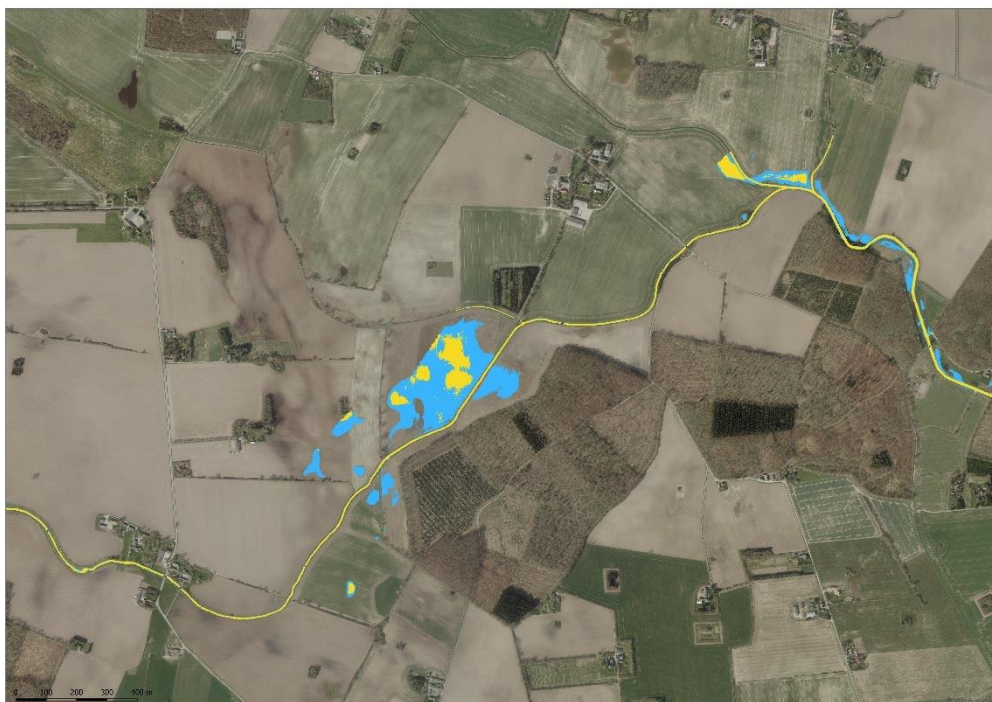
Figur 5. Referenceberegning ved vintermedianmaksimumafstrømning (blå arealer) og sommermedianmaksimumafstrømning (gule arealer). De blå/gule arealer dækker et område, der allerede kan erkendes som vandlidende på luftfoto fra forår 2018.
