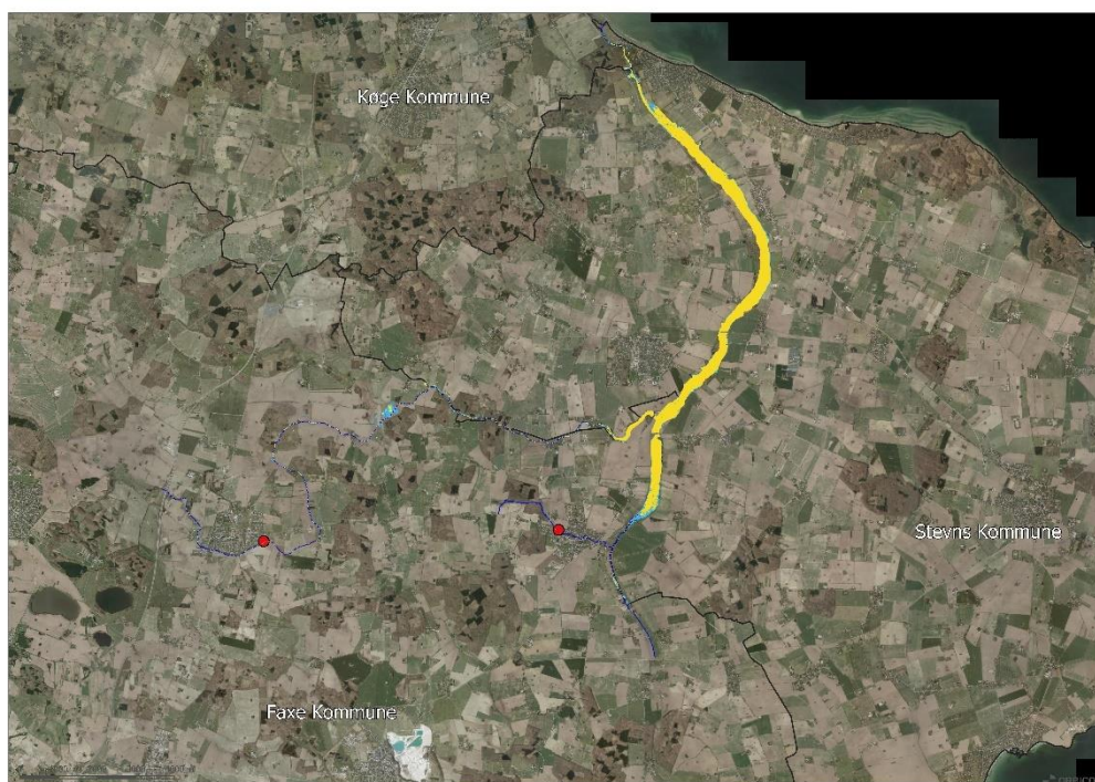
Figur 4: Referenceberegning ved vintermedianmaksimumafstrømning 0,259 l/s/ha (blå arealer) og sommermedianmaksimumafstrømning 0,581 l/s/ha (gule arealer). Luftfoto forår 2018.
