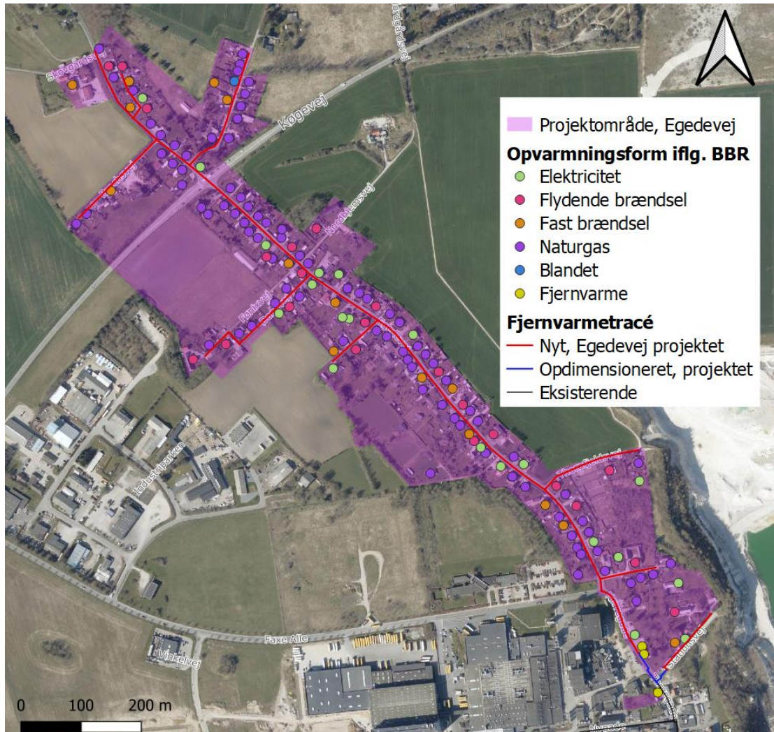
Figur 2. Hovedkilde til eksisterende opvarmning af ejendomme i området iht. BBR, samt nyt fjernvarmetracé.
